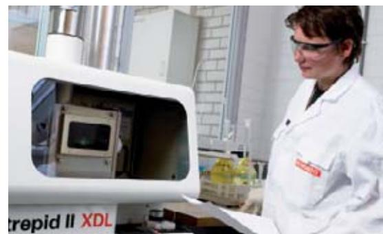
In het kader van de ingangscontrole vindt in het eigen laboratorium van alle materiaalleveranties een digitale foto- en gewichtsregistratie plaats, gevolgd door een kwalitatieve en kwantitatieve analyse.
