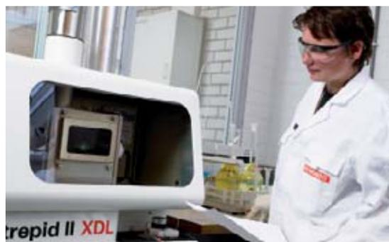
Im Rahmen der Eingangskontrolle erfolgt für alle Materialchargen eine digitale Foto- und Gewichtsregistrierung sowie eine qualitative und quantitative Analyse im eigenen Labor.
