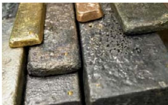
Das Zwischenergebnis der Aufbereitung sind Barren, für deren Homogenität wir uns verbürgen. In den Barren sind sämtliche Edelmetalle, die wir von Ihnen erhalten haben, in gemischter Form enthalten – die Zusammensetzung wird im Labor exakt analysiert.
